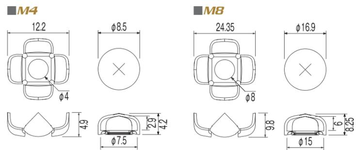
常に脱落の危険性がある後付け保護キャップを改良。ネジ頭の保護・絶縁・装飾・断熱・簡易セキュリティー機能も付与出来るセットタイプのネジ頭保護キャップ。
